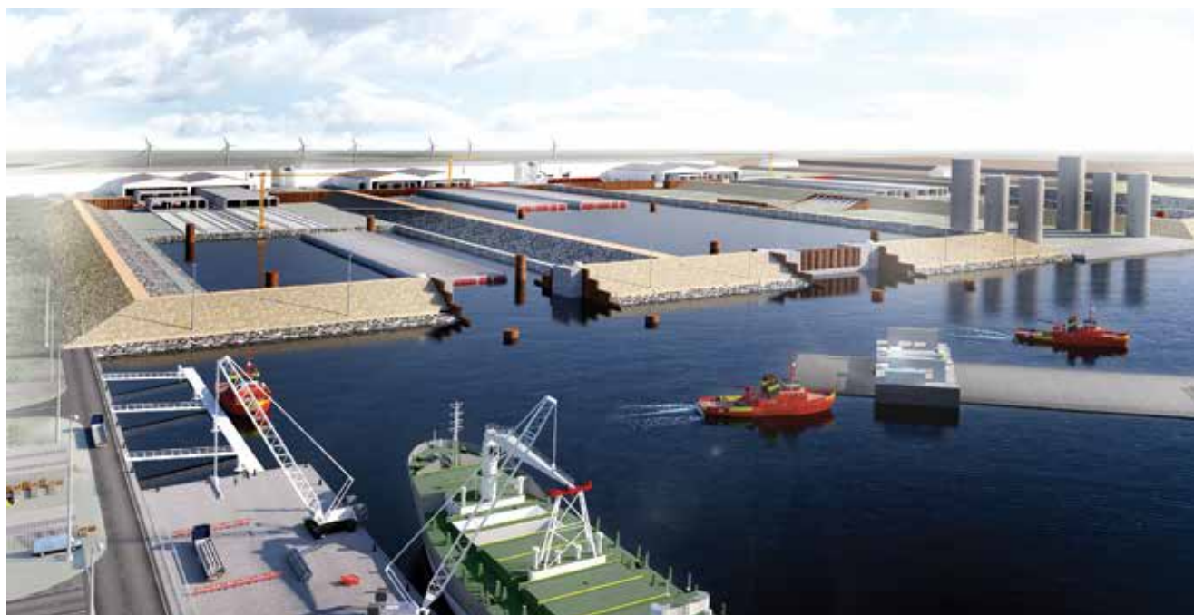
Shema transporta tunelskog elementa iz radne luke na gradilište tunela
